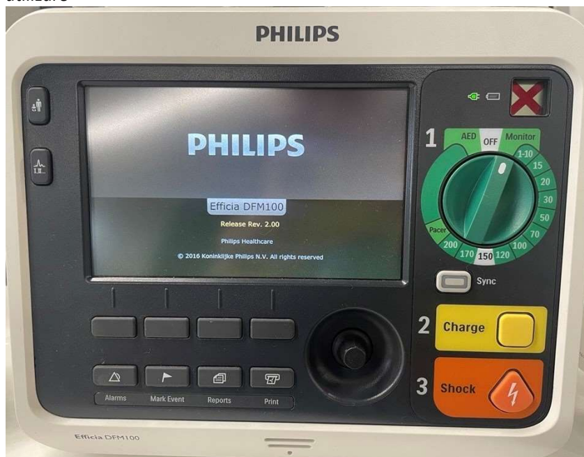
Figura 1: Exemplu de ecran de întâmpinare DFM100 cu un „X” roșu continuu în indicatorul Pregătit de utilizare
